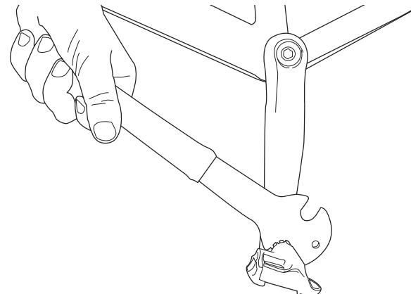
2. Placez le PW-3 sur la pédale droite. En vous servant de la manivelle gauche comme levier, faire tourner le PW-3 dans le sens inverse des aiguilles d'une montre, jusqu'à retirer la pédale.
