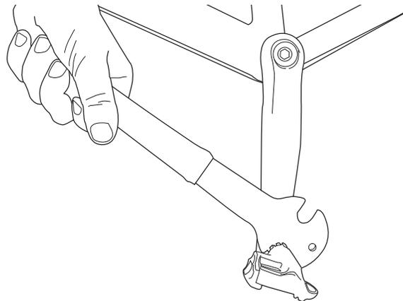
2. Placez le PW-3 sur la pédale droite. En vous servant de la manivelle gauche comme levier, faire tourner le PW-3 dans le sens inverse des aiguilles d'une montre, jusqu'à retirer la pédale.
