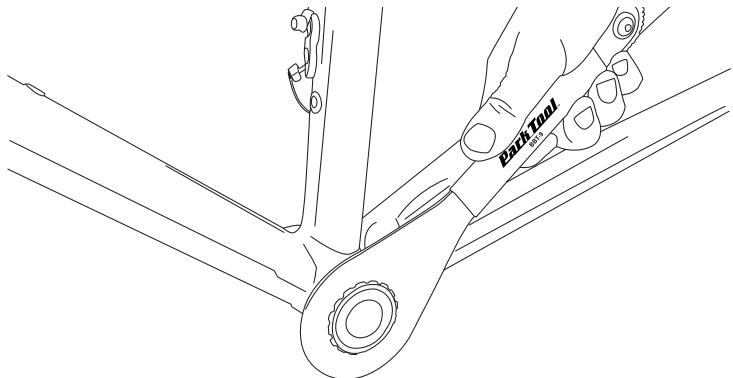
2. Ajuster la clé pour boîtier de pédalier sur la cuvette droite et tourner dans le sens des aiguilles d'une montre (dans le sens inverse des aiguilles d'une montre pour les cuvettes à pas italien).
