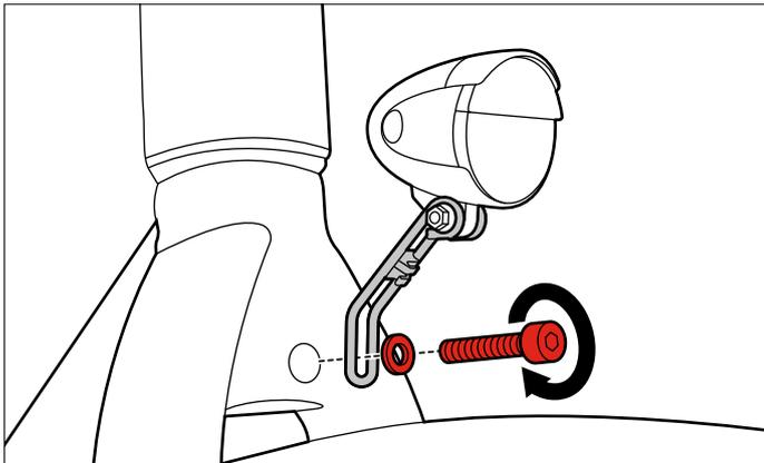
Der ZL 850 Halter muss fest an der vorgefertigten standardisierten Bohrung angebracht werden.
