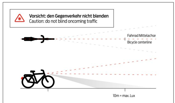
Richten Sie den Frontscheinwerfer auf die Mittelachse des Fahrrads aus.
