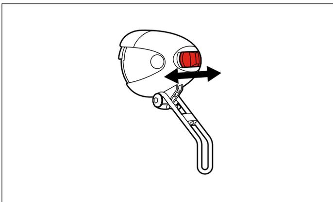
Verschieben Sie den Schalter, um den Frontscheinwerfer ein- oder auszuschalten (achten Sie darauf, dass der Dynamo Strom liefert).
