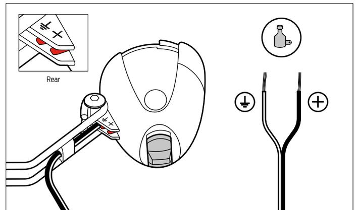
Verbinden Sie das mitgelieferte Kabel mit dem Frontscheinwerfer und dem Dynamo (6V).
