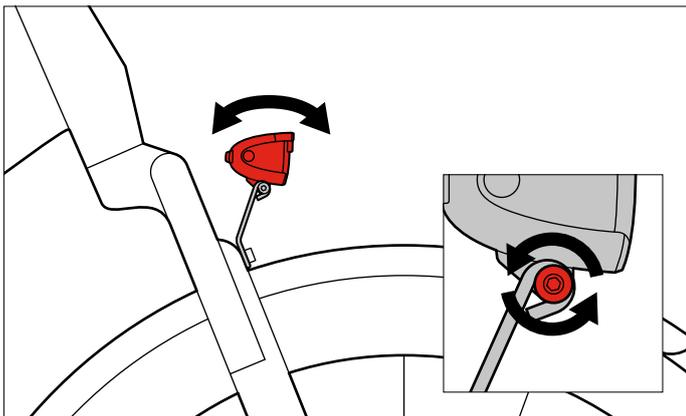
Verstellen Sie den Winkel des Frontscheinwerfers mit einem Inbusschlüssel.
